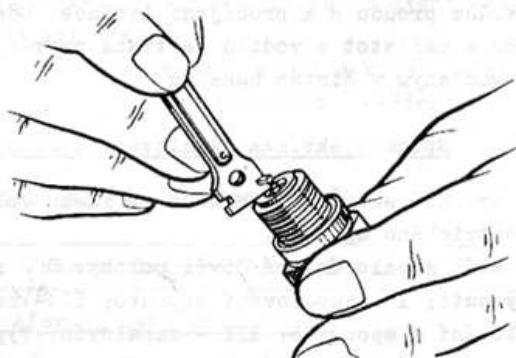
Obr.234. Seřízení jiskrové vzdálenosti ve svíčce
