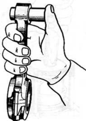
Obr.65. Výběr pístního čepu k ojnicí
