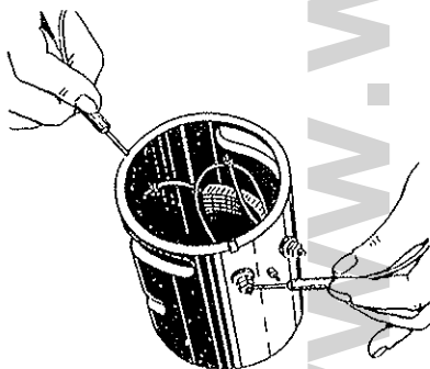
Bild 248 Prüfung der Klemmen und der Erregerwicklung auf Masseschluß
